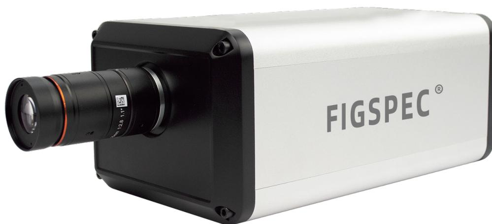
FigSpec®系列成像高光谱相机采用高衍射效率的透射式光栅分光模组与高灵敏度面阵列相机、结合内置扫描成像及辅助摄像头技术，解决了传统高光谱相机需外接推扫成像机构及调焦复杂等难以操作的问题。可与标准C接口的成像镜头或显微镜直接集成，实现光谱影像的快速采集。
