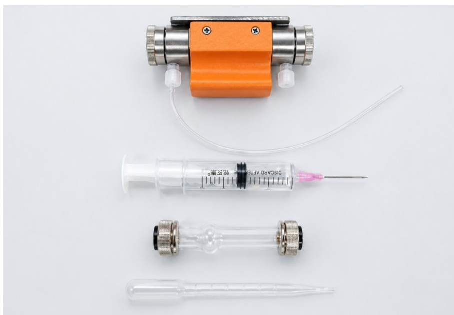
图 5-2 装样工具与部件检查
