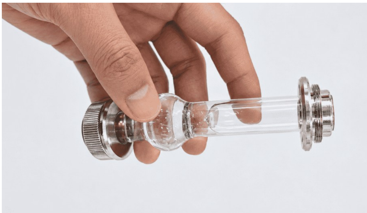
图 5-3 待测样品润洗旋光管
