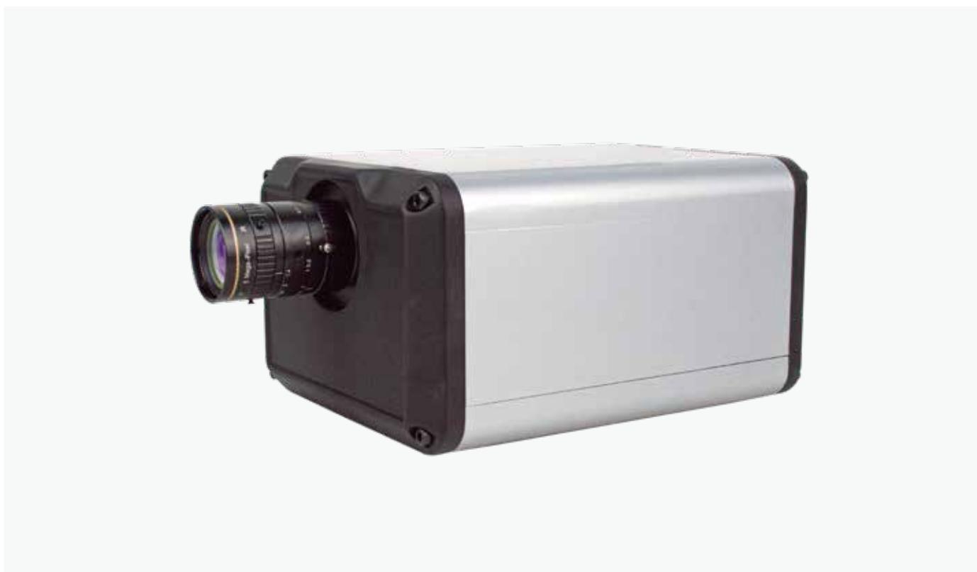
FS-27成像高光谱相机采用高衍射效率的透射式光栅分光模组与高灵敏度面阵列相机、结合内置扫描成像及辅助摄像头技术，解决了传统高光谱相机需外接推扫成像机构及调焦复杂等难以操作的问题。可与标准C接口的成像镜头或显微镜直接集成，实现光谱影像的快速采集。
