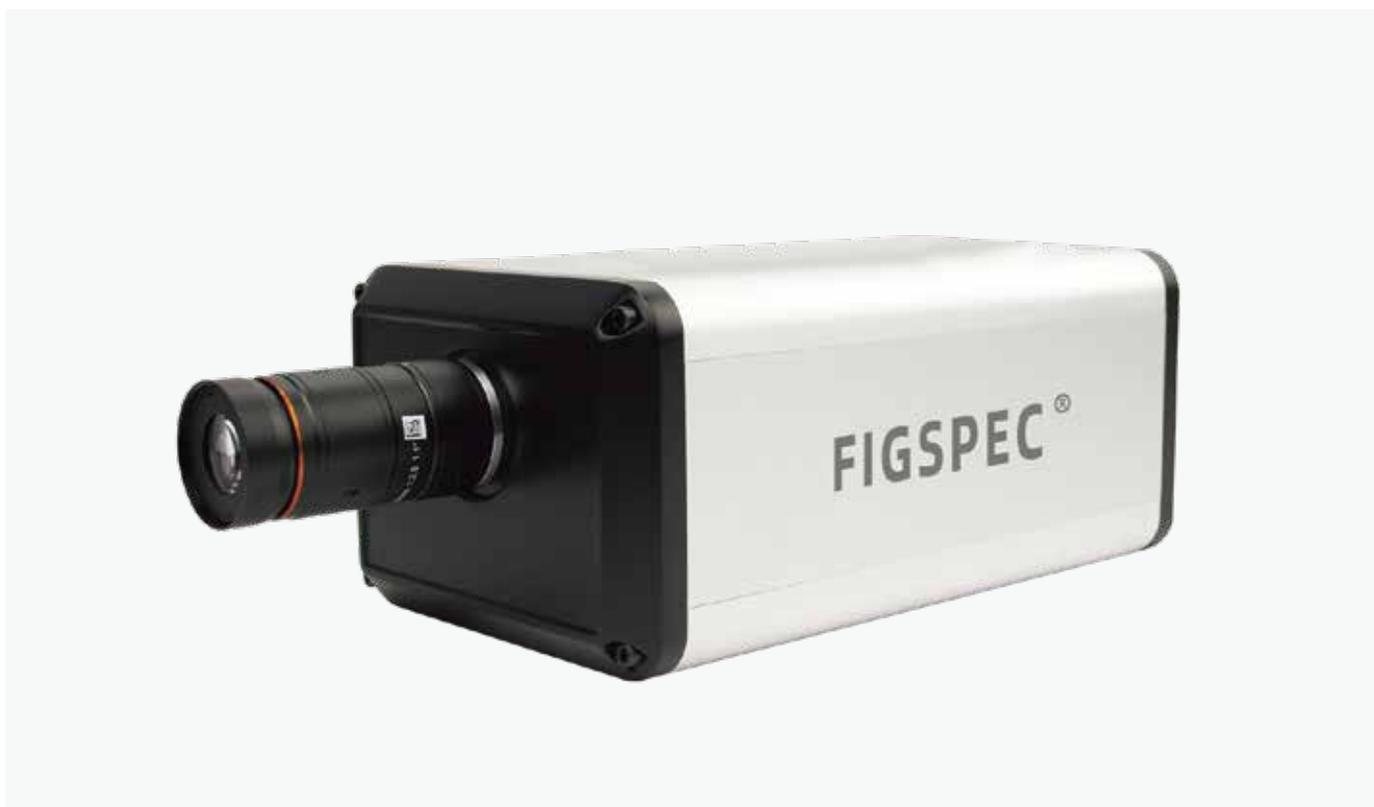
FigSpec®系列成像高光谱相机采用高衍射效率的透射式光栅分光模组与高灵敏度面阵列相机、结合内置扫描成像及辅助摄像头技术，解决了传统高光谱相机需外接推扫成像机构及调焦复杂等难以操作的问题。可与标准C接口的成像镜头或显微镜直接集成，实现光谱影像的快速采集。
