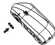
将替换的测量口径旋转扣准
